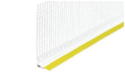
10 cm Überstand fest auf den Selbstklebestreifen der Schutzlasche aufdrücken. Schutzfolie zur gegenüberliegenden Seite und nach oben spannen und jeweils dort auf Selbstklebestreifen aufdrücken. Überstehende Schutzfolie mit einem Cuttermesser entlang der Sollbruchkante der Schutzlasche abtrennen. Folie darf auf keinen Fall in das Profil hineinragen und damit eingeputzt werden.
