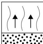
Zwischenabluft zwischen den Spritzgängen bis matt abgezogen = ca. 5 min.
