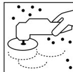
Für den Trockenschliff mit Maschine wird die Verwendung von Softscheiben mit Schaumrücken P 360 - P 500 oder Netzschliffscheiben empfohlen.
