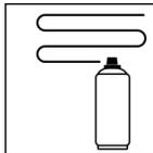
Trockenfilmschichtdicke bis zu max. 150 µm (ca. 2 - 3 Spritzgänge) / 35 µm pro Spritzgang
