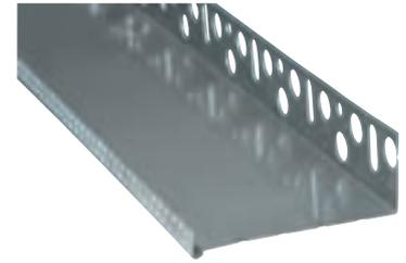
**Anwendungsbereich:** Gekantetes Leichtmetallprofil für eine fluchtgerechte, saubere Ausbildung des unteren und gegebenenfalls seitlichen WDVS-Abschlusses. Darüber hinaus auch für Detailausbildungen, z.B. an Dachschrägen oder als unterer Abschluss an Rollladenstürzen. Anwendbar in allen Arcutherm® WDV-Systemen.
